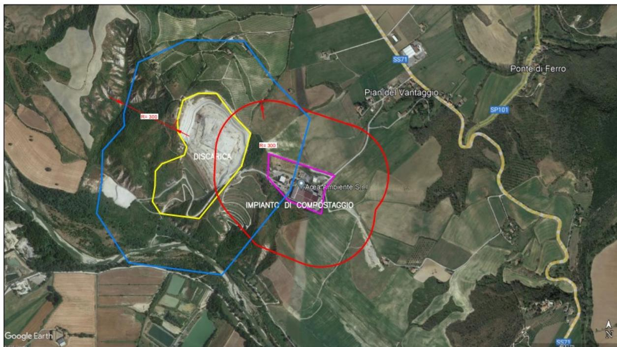
Figura 15 – distanza di danno dal polo impiantistico in caso di incendio
